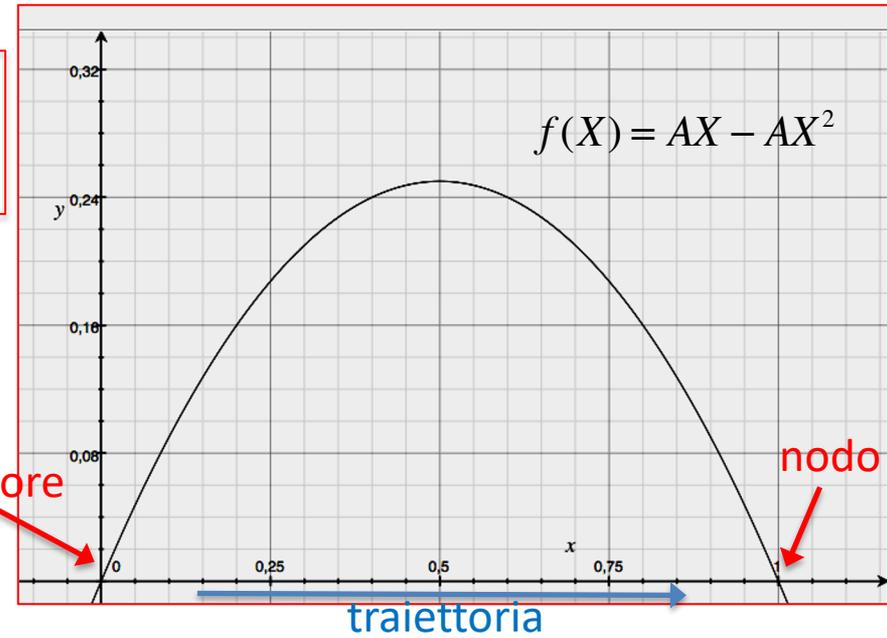
$$\rightarrow \begin{cases} \lambda(X_0 = 0) = A > 0 & \rightarrow X_0 = 0 \text{ è un repulsore (punto fisso repulsivo - instabile)} \\ \lambda(X_0 = 1) = A - 2A = -A < 0 & \rightarrow X_0 = 1 \text{ è un nodo (punto fisso attrattivo - stabile)} \end{cases}$$
